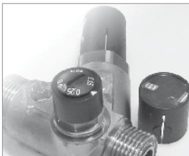
**TemCon<sup>+</sup>** il tappo di plastica e smontabile per mezzo di un cacciavite piatto inserito nella fessura del tappo come nel manuale di riferimento by-pass può essere impostato in maniera graduale a un KV-valore compreso tra 0.0 e 0.3.
